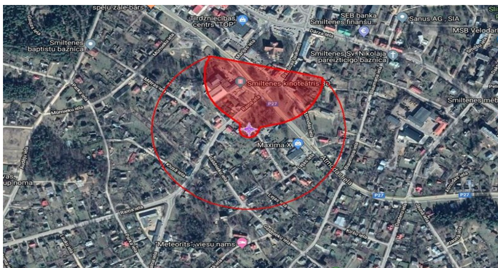
22. attēls. Benzīna noplūdes no autocisternas toksisko tvaiku koncentrācijas izplatība
