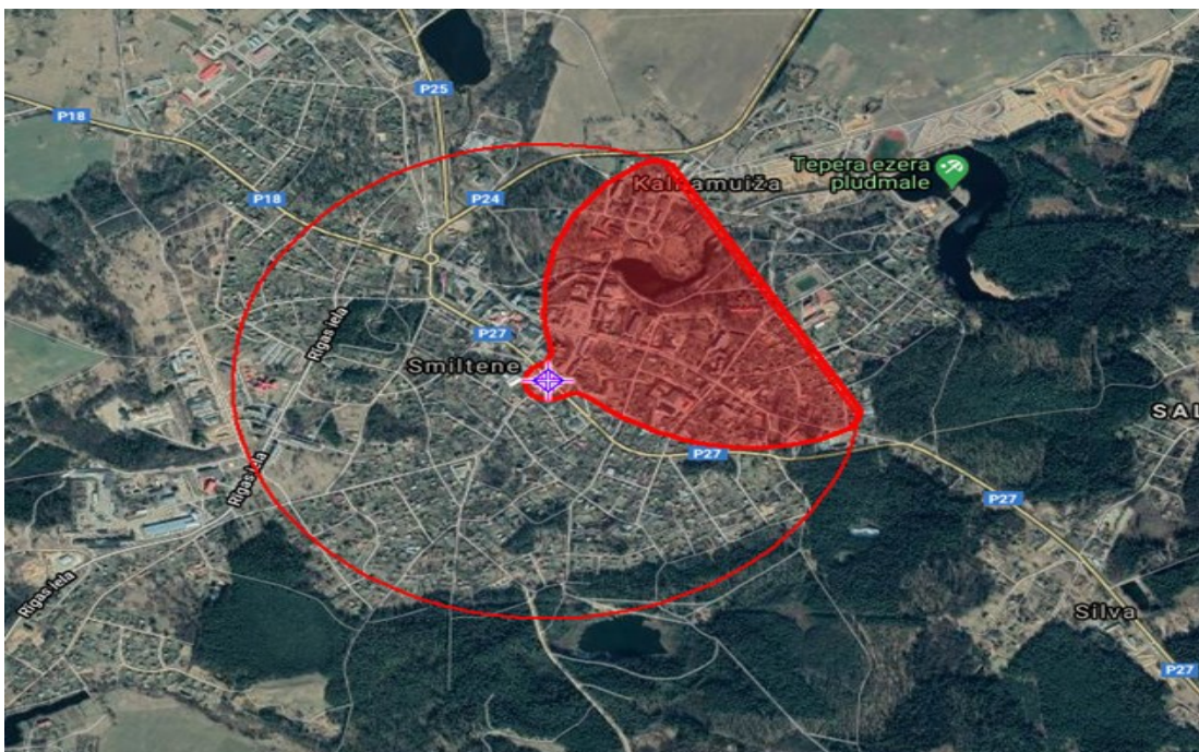
25. attēls. Sašķidrinātās naftas gāzes noplūdes no autocisternas toksisko tvaiku izplatība
